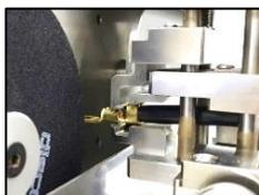
搬送にステッピングモーター搭載し全自動でカット研磨を行います。人の手による作業誤差をなくします。
