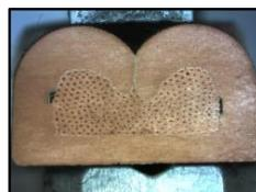
5sq~最大 60sq までの極太電線にも対応しました。バキュームユニットで粉塵を吸い込みながら、カットのみで綺麗な断面を作成します。
