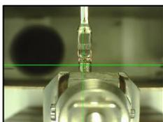
モニターを見ながら前後調整ダイヤルを使用することで、計測位置の正確な位置出しができます。
