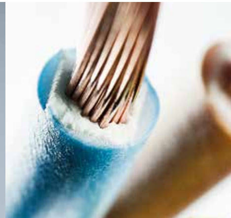
4枚刃回転式で切り込み(写真下)。 非常に高い精度の切り込み、V刃での切り込みよりもきれいな切り口が可能(写真上)。
